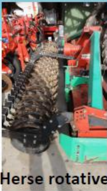
Semoir de céréales combiné avec herse rotative
